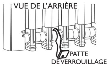
3 Faites pivoter la patte de verrouillage de façon à pouvoir la fixer au mur.
