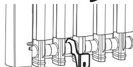
4 Vissez la patte de verrouillage au mur pour garantir un bon maintien du radiateur.
