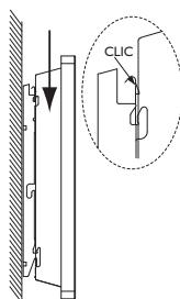
Pour déverrouiller le panneau rayonnant de la patte d'accrochage, munissez-vous d'un tournevis plat et **poussez la languette** (située en haut à gauche de la patte d'accrochage derrière l'appareil) **vers le mur**.
