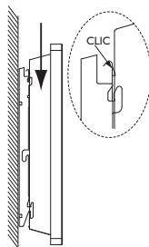
Om het straalpaneel van de haak af te halen, hebt u een platte schroevendraaier nodig en **moet u het tongetje naar de muur toe duwen** (bevindt zich bovenaan links van de haak achter het apparaat).
