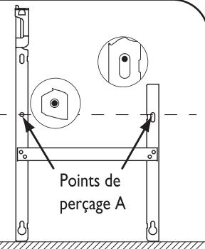
Les points de perçage A donnent la position des fixations inférieures.
