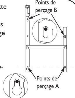
Les points de perçage B donnent la position des fixations supérieures.
