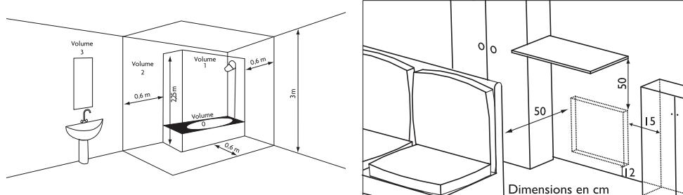
Neem de minimale afstanden in acht ten opzichte van meubels bij het kiezen van de plaats waar het apparaat geïnstalleerd moet worden.
