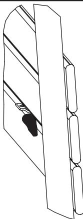
Teneinde de pin te demonteren, verwijder het vergrendelingsmechanisme door het lichtjes te kantelen.
