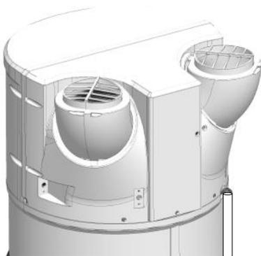
Selon l'humidité de l'air, il peut se former **jusqu'à 0,25l/h de condensats**. L'écoulement de ces condensats ne doit pas être réalisé de manière directe à l'égout, car les vapeurs d'ammoniac qui refoulent de l'égout pourraient endommager les lamelles de l'échangeur de chaleur et les pièces de la pompe à chaleur.
