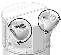
**1** Dévisser les vis de blocage des bouches puis les orienter dans la direction choisie en effectuant un mouvement de rotation
