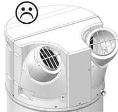
**4** Ne pas orienter les bouches l'une vers l'autre. Configuration interdite car recirculation de l'air froid dans l'appareil !
