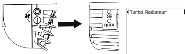
Le voyant ● FILTER s'allume en orange lorsqu'il doit y avoir un nettoyage du filtre ou lorsque la sortie d'air a été bouchée (reportez-vous page 8-9).
