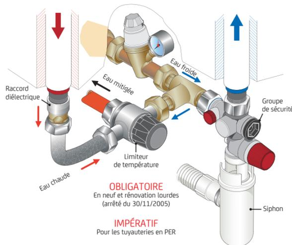
La tuyauterie doit supporter une T° de 100 °C et 10 bars. Dans le cas contraire, mettre un limiteur de température en sortie **DIRECTE** du chauffe-eau.
